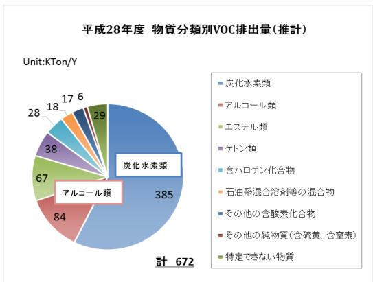
尚、塩素系溶剤は含ハロゲン化合物に該当し、ジクロロメタン、トリクロロエチレン、テトラクロロエチレン他(フッ素系、臭素系を含む)がここに推計されています。
